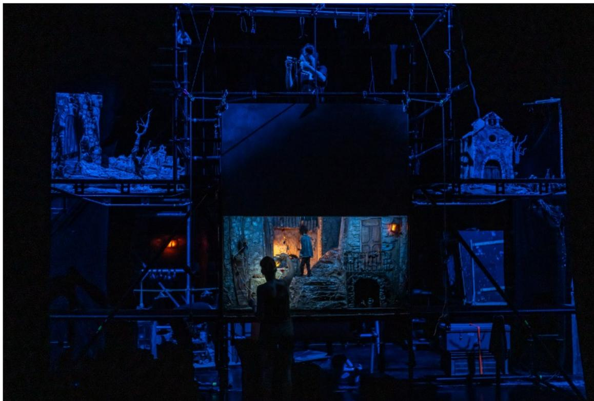
Sur scène, assez proche du public, on voit un castelet en bois, grand, à l'allure a cienne et massive, avec son écran de scène fermé dans un premier temps. Son fronton cache sa réelle nature technique: une très grande structure d'acier avec pont de manipulation, rails latéraux pour la circulation des décors pleins, machineries de levage, de patiences, machines à neige et autres éléments mobiles ! Derrière, des chariots, des tringles, les 10 décors et les 30 marionnettes.
